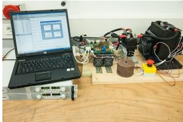
Banco prova per test di invecchiamento su singole batterie
